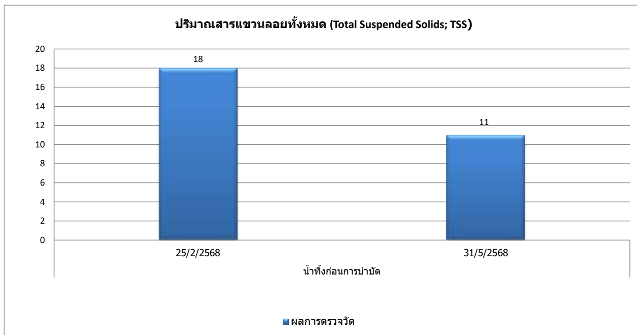
กราฟที่ 3.1-3 กราฟเปรียบเทียบผลการตรวจวัดปริมาณของแข็งแขวนลอย (Total Suspended Solids) จากน้ำทิ้งก่อนบำบัด เดือนกุมภาพันธ์ และพฤษภาคม พ.ศ.2568
